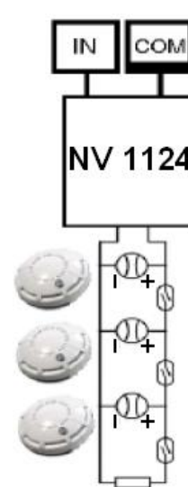
шлейф пожарных двухпроводных извещателей
